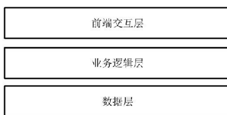
图7-4 MVC模式下的软件分层结构
